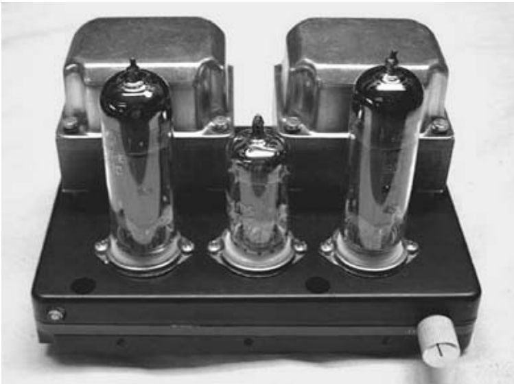
Abb. 5.16 Der Stereoverstärker im Festplattengehäuse
