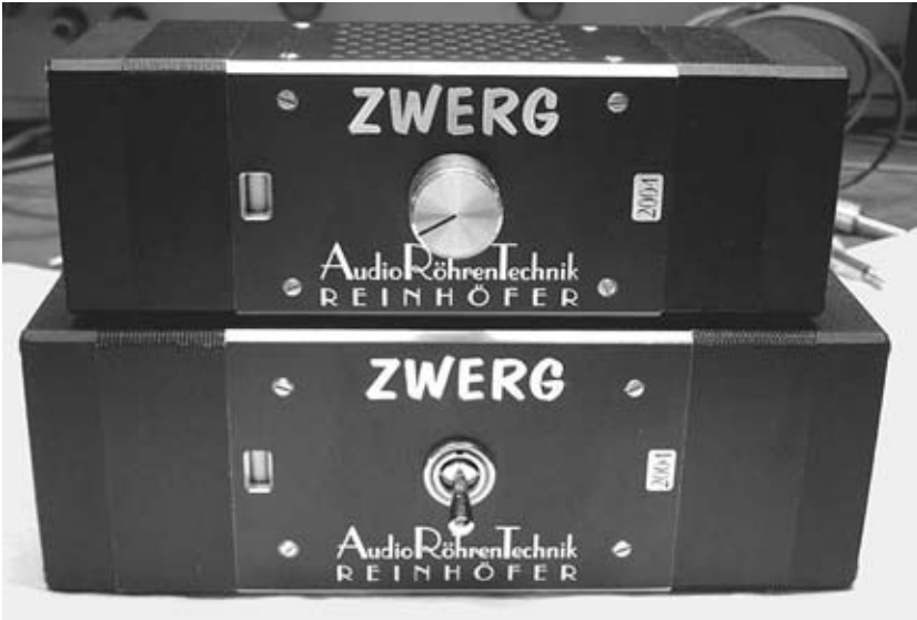
Abb. 5.10 Der Verstärker mit abgesetztem Netzteil
