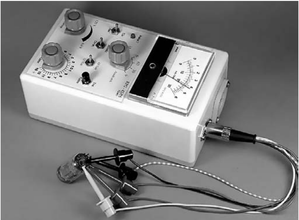
Abb. 9.4 Prüfen einer Röhre mit dem Adapterkabel
