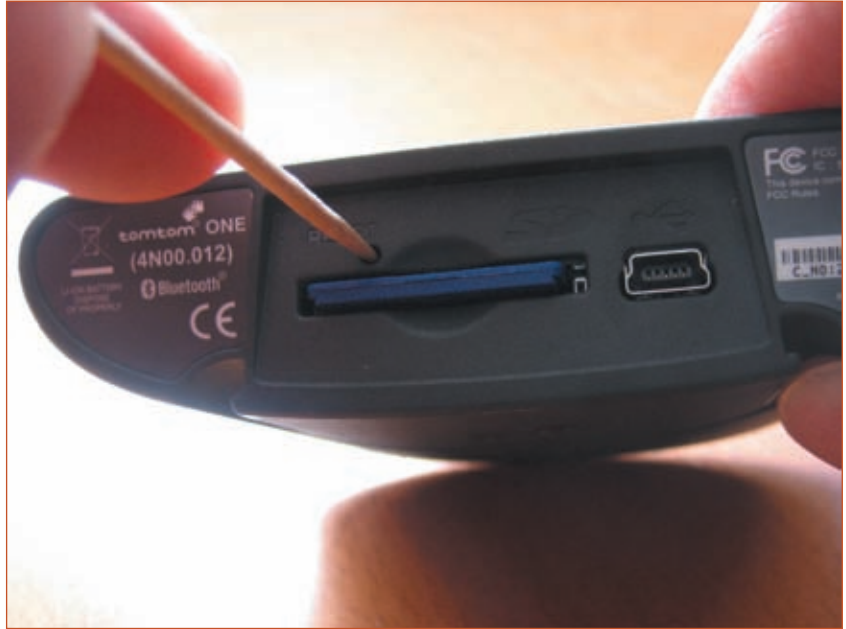
Abb. 3.4 – Mit dem Zahnstocher können Sie den Reset-Knopf eindrücken und so das Gerät neu starten.
