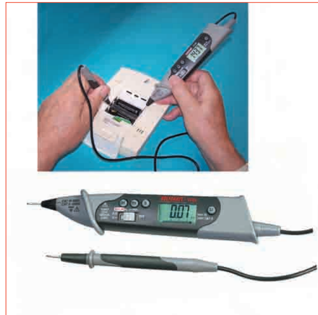
Abb. 3.3 – Für eine schnelle Überprüfung der Batteriespannung eignet sich ein Stift-Multimeter am besten (Foto/Anbieter: Conrad Electronic).
