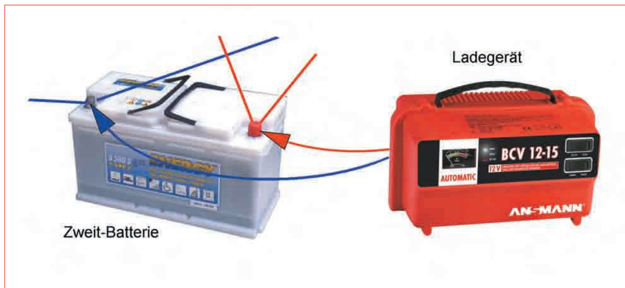
Abb. 12.4 – Die zusätzliche Batterie aus Abbildung 12.2 kann bei Bedarf durch ein externes Netzladegerät geladen werden, wobei sie an die Autobatterie angeschlossen bleiben darf.
