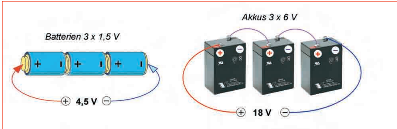
Abb. 3.1 – Werden mehrere Batterie- oder Akkuglieder (Zellen) in Reihe geschaltet, addieren sich die Spannungen einzelner Glieder.
